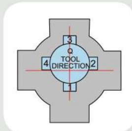
Multi - keyway 多槽等角度插削
